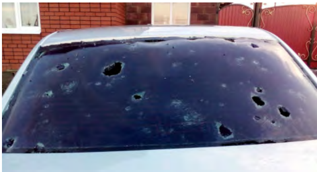
Рис. 27 — Последствия крупного града
